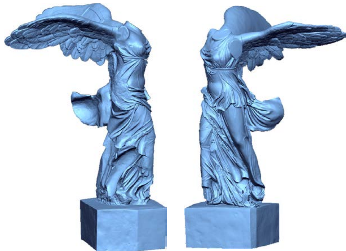
La scansione 3D finale. Modello chiuso pronto per la stampa 3D
